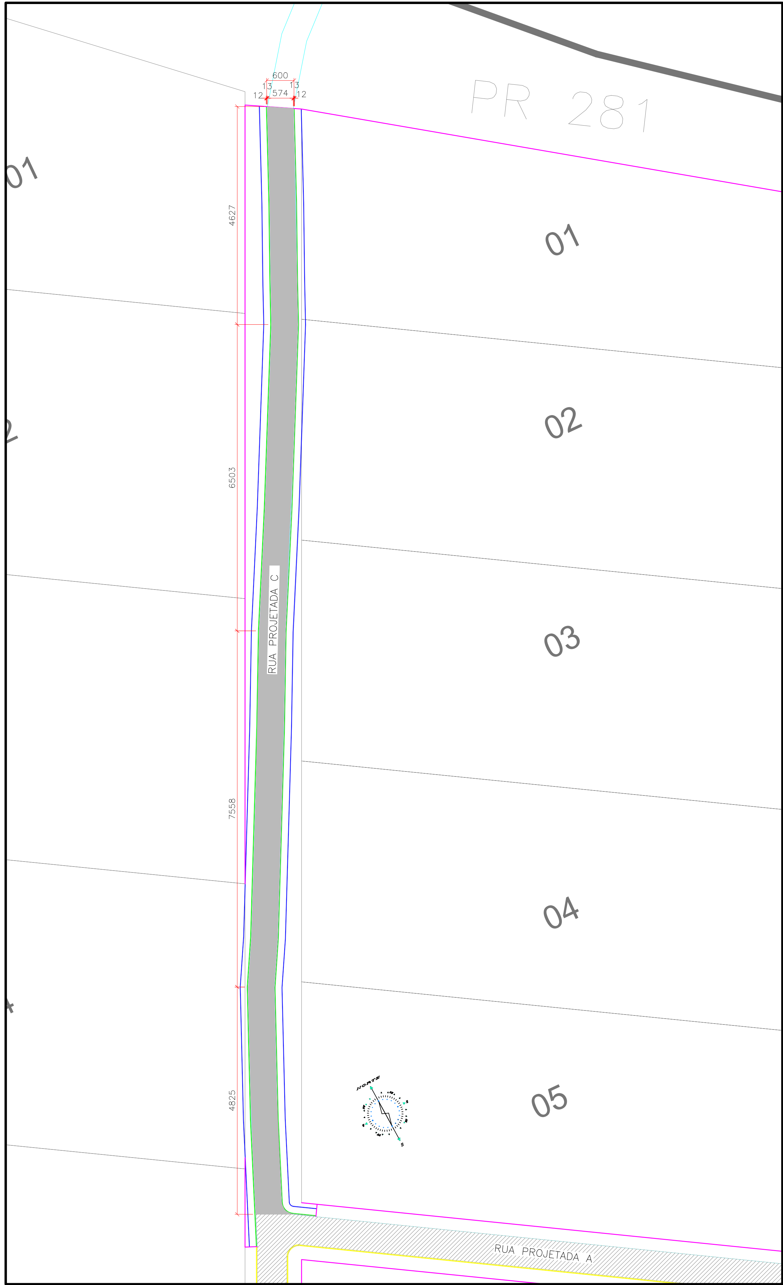
PLANTA BAIXA Área de Pavimentação: 2.576,46 m² Escala: 1/500
