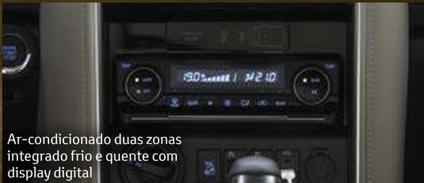
Ar-condicionado duas zonas integrado frio e quente com display digital
