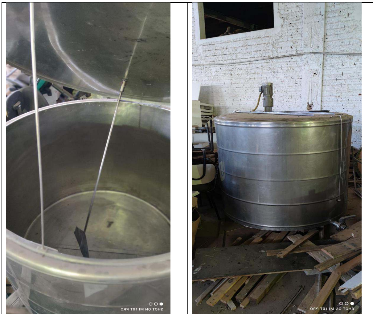
FOTOS 01 -02 -03 e 04: TANQUE EXPANSÃO-TECNOFRIO 600 LITROS.
