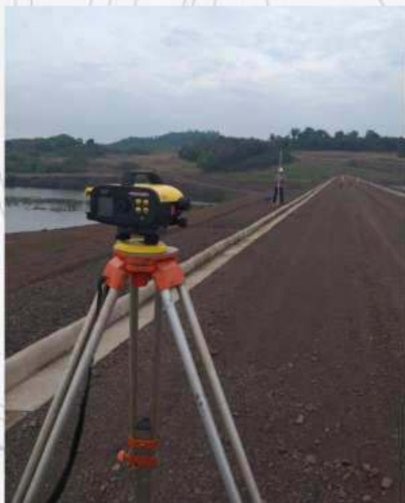
Nivelamento e Contra Nivelamento para monitoramento de NA para a empresa CEBI. Consorcio Empreendedor Baixo Iguaçu.
