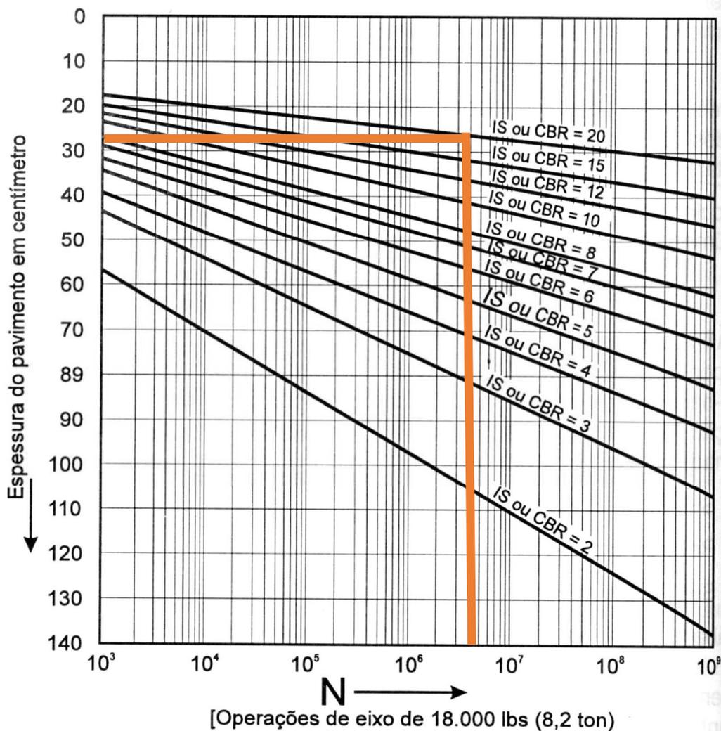
>> **Determinação da espessura da camada SOBRE O SUBLEITO.**
